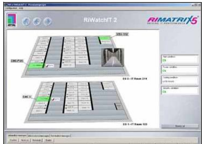
Via het Viewmoduul kunnen alle belangrijke actieve componenten zoals UPS, CMC-TC-sensoren en Power System Module PSM gevisualiseerd worden.
